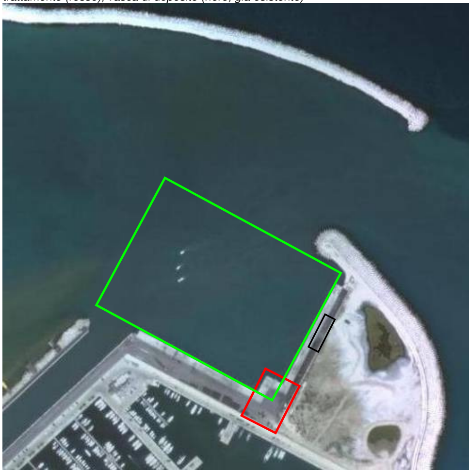
Figura 1 – Porto di Pescara: ubicazione area di dragaggio (verde), area di ubicazione impianto di trattamento (rosso), vasca di deposito (nero, già esistente)
